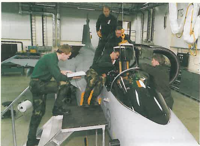
▲▲+▲ Alla praktiska övningsmoment, som här imontering av en raketstol, sker i hangaren, som ligger i direkt anslutning till teorisalarna en trappa upp.
